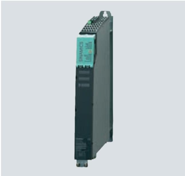
如果取消了电源模块的再生回馈能力，要在掉电或者紧急回退 /1 类紧急停机情况下使驱动受控停止运转，或者要限制短暂制动下的直流母线电压，就必须使用制动模块和配套的外部制动电阻。制动模块含有功率电子件和对应的控制回路。运行期间，直流母线中的电能被转换为外部制动电阻中的热量损耗。制动模块自动运行。多个制动模块可以并联在一起。此时，每个制动模块必须具有单独的制动电阻。
