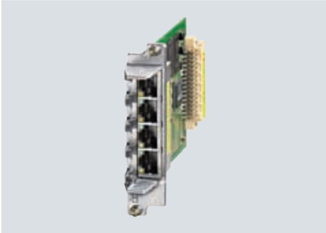
通讯板 CBE20 用于通过一个控制单元 CU320 连接到 PROFINET IO 网络。
