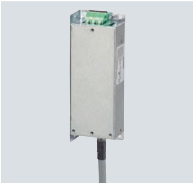
在 EMC 要求严格的使用现场，用于结构尺寸 FSA 的输入滤波器可以将 PM340 功率模块输出的传导性干扰降低到 EN 61800-3 规定的 C2 类极限值。输入滤波器只能直接连接到 TN 接地电源系统。
