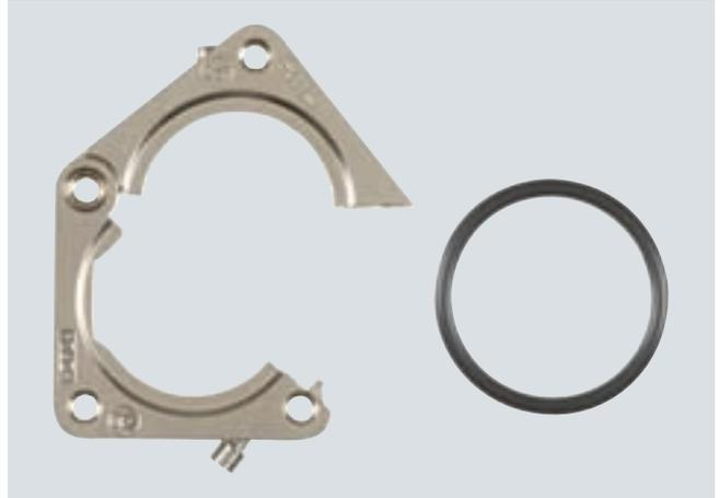
安装法兰可用于在例如控制柜中敷设或固定连接器, 以达到 IP67 的防护等级。对于带角度的连接器, 可将安装法兰向后安装在带联管螺母或外螺纹的连接器上。
