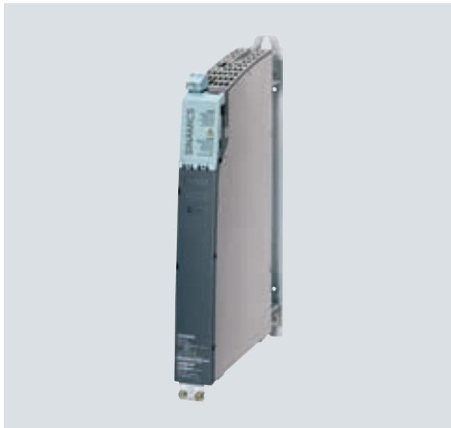
书本型控制电源模块，即 Control Supply Module，简称 CSM，通过电网或直流母线提供 24 V DC 电源。例如：在电网掉电时，如果存在直流母线电压，便可以执行紧急回位运动。
