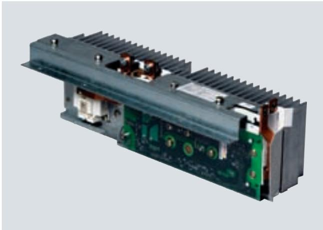
如果取消了电源模块的再生回馈能力，要在掉电或者紧急回退 /1 类紧急停机情况下使驱动受控停止运转，或者要限制短暂制动下的直流母线电压，就必须使用制动模块和配套的外部制动电阻。制动模块含有功率电子器件和对应的控制回路。运行期间，直流母线中的多余电能由外部制动电阻消耗。制动模块自动工作。多个制动模块可以并联在一起。此时，每个制动模块必须具有单独的制动电阻。
