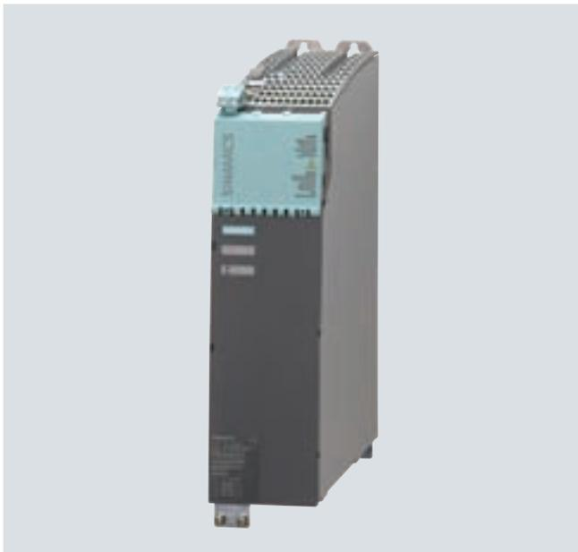
调节型电源模块（Active Line Module），简称 ALM，是一个自控的整流 / 回馈单元，其中 IGBT 负责整流和回馈，它产生一个可控的直流母线电压。这样相连的电机模块便可以从电源电压上解耦，而允许范围内的电源电压波动不会对电机电压产生影响。ALM 适用于接地的星型 TN、TT 供电系统和不接地的对称 IT 供电系统。
