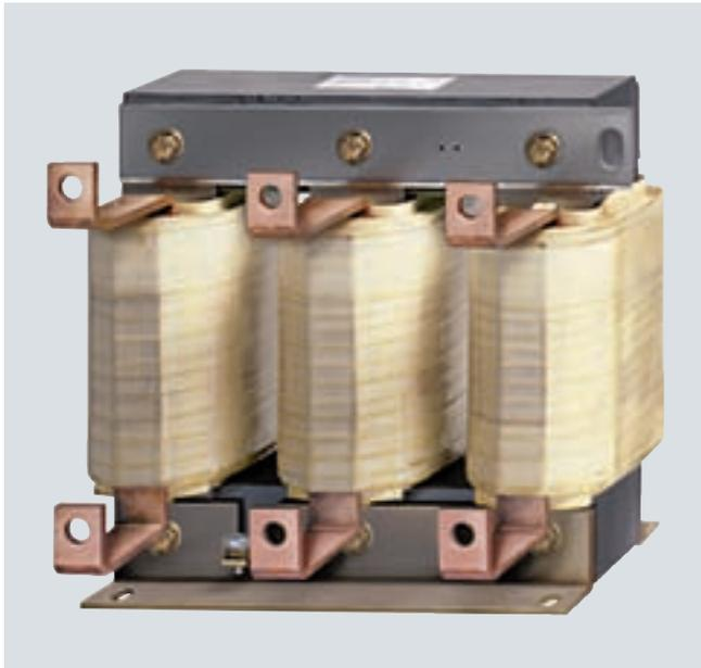
对于某些低漏电感、难以调整控制环设置的特殊电机，可能需要使用一个三柱铁心串联电抗器。根据经验，这种电机一般是定子频率 > 300 Hz 的电机，或者额定电流 > 85 A 的电机。
