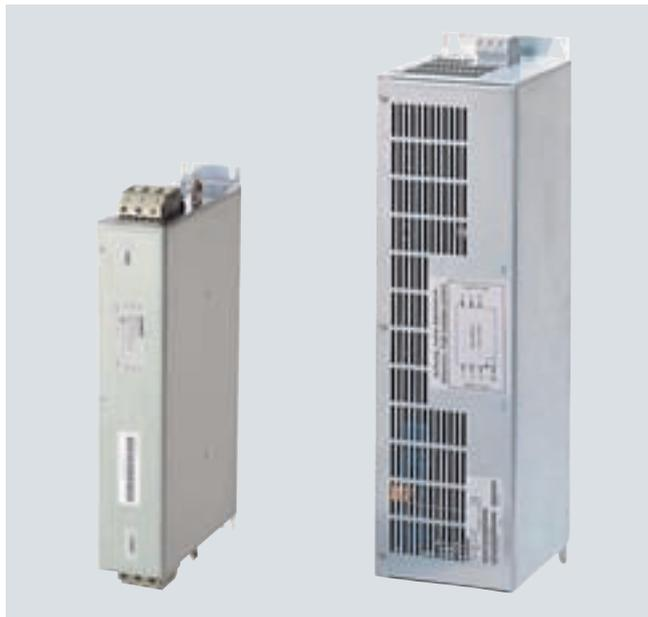
在 EMC 要求严格的使用现场，输入滤波器和进线电抗器协同工作，可以将从功率模块输出的传导性干扰降低到 EN 55011 规定的 A1 类极限值 和 EN 61800-3 规定的 C2 类极限值。输入滤波器只能直接连接到 TN 接地电源系统。
