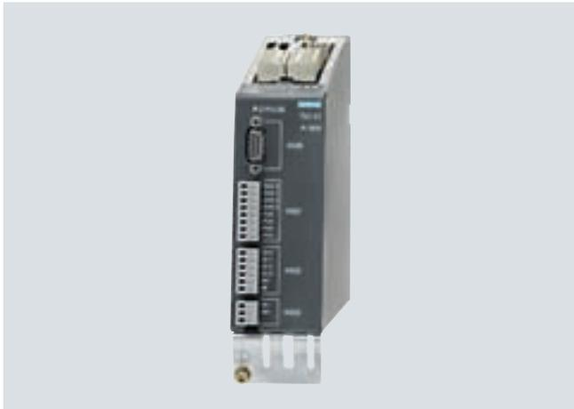
端子模块 TM41 向上级控制器发送 TTL 信号，作为增量编码器的仿真信号。编码器接口（增量编码器仿真）通过参数设置可以连接到控制单元发出的编码器信号，例如：sin/cos 增量编码器。
