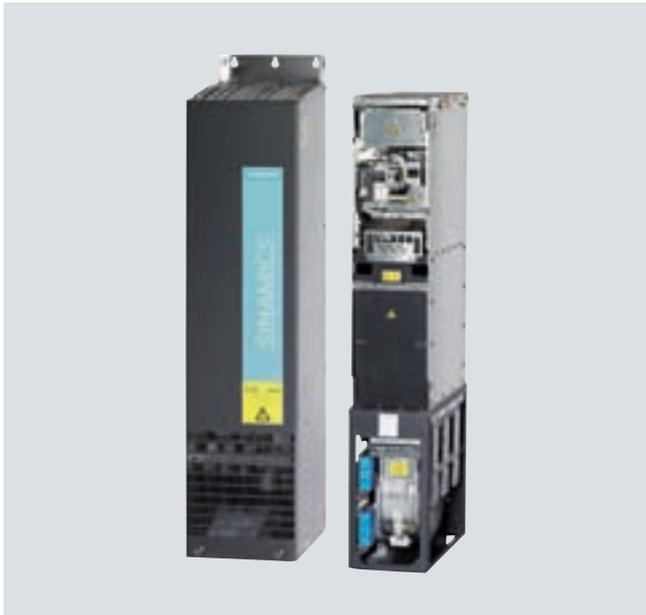
调节型接口模块 AIM 用于和装机装柜型调节型电源模块 ALM 组合使用。AIM 包含一个具有基本 RI 抑制功能的清洁输入滤波器、用于 ALM 的预充电电路、进线电源电压采集电路和监控传感器。FI 和 GI 结构尺寸中已经集成了一个旁路接触器，使结构紧凑、简洁。
