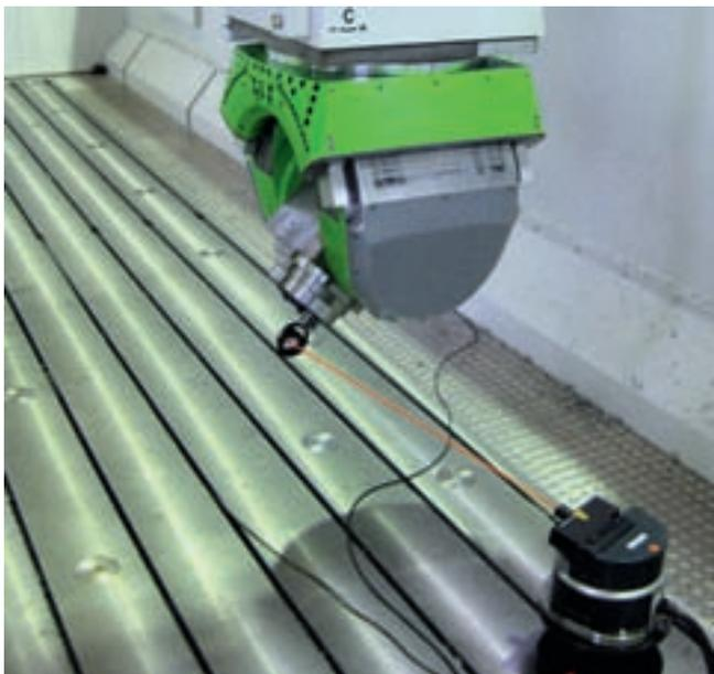
大型龙门式铣床中的 LaserTRACER
