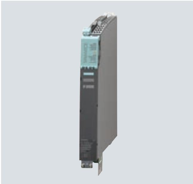
非调节型电源模块 (Smart Line Module), 简称 SLM, 是稳定的整流 / 回馈单元。其中, 二极管电桥负责整流; IGBT 负责回馈, 具有 100% 的持续回馈功率。在 5 kW 和 10 kW 型 SLM 上, 通过一个数字量输入可以禁用回馈模式; 在 16 kW 和 36 kW 型 SLM 上, 通过设定参数禁用回馈。SLM 适用于接地的星型 TN、TT 供电系统和不接地的对称 IT 供电系统。
