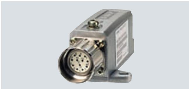
外部编码器模块 SME20/SME25 是用于机器编码器（直接测量系统）信号的转换单元。它外壳的防护等级设计为 IP67。这样模块便可以安装在控制柜外、靠近编码器的地方。
