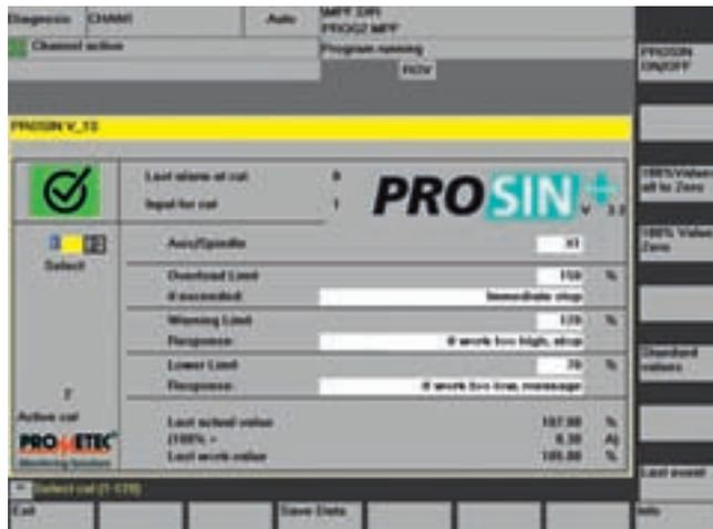
作为用于 SINUMERIK 840D/840D sl 控制系统的集成软件解决方案的 PROSIN PLUS 刀具监控
