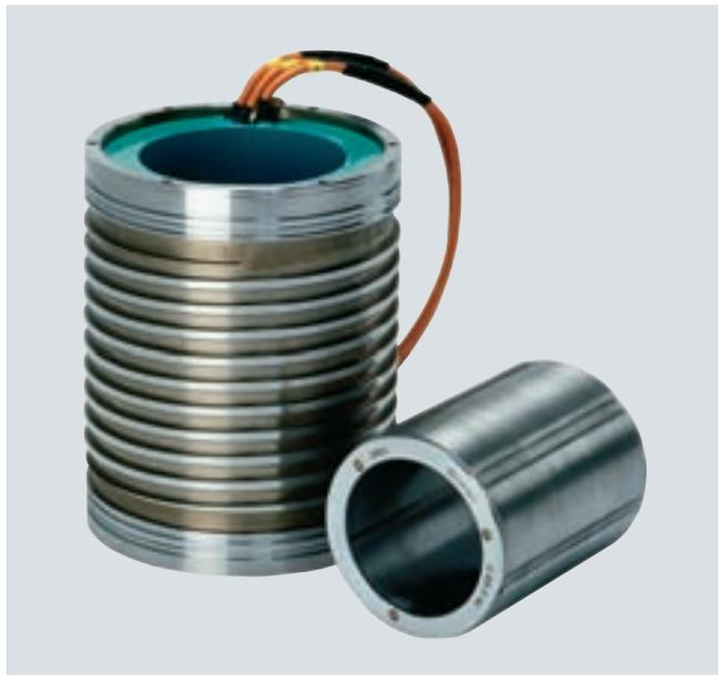
1FE1 内置电机为采用水冷的同步电机，其被供应用作定子和转子组件。将转子安装到主轴箱内的主轴上后则形成一个完整的主轴单元。
