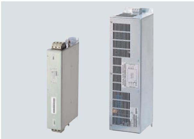
在为满足 EMC 要求而经过专门设计的使用现场，输入滤波器和调节型接口模块 AIM 或 HFD 进线电抗器协同工作，可以将功率模块输出的传导性干扰降低到 EN 61800-3 规定的 C2 类极限值。输入滤波器只适合直接连接到 TN -电源系统。
