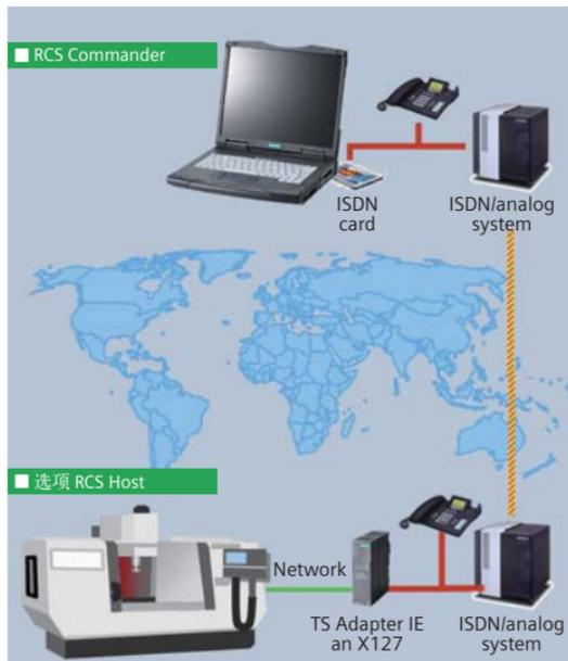
RCS Host 远程诊断功能，实现远程诊断电脑与 CN 系统之间“点对点”远程诊断功能
