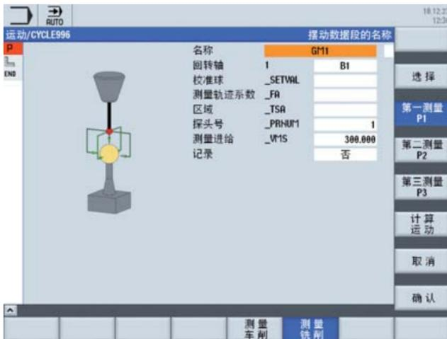
840D sl 系统在激活运动测量循环后，利用 5 轴标定测量功能，可以通过 3D 测头对空间球体的位置进行测量，利用测量空间内的曲面位置计算用于定义 5 轴转换（TRAORI 和 TCARR）的几何矢量。
