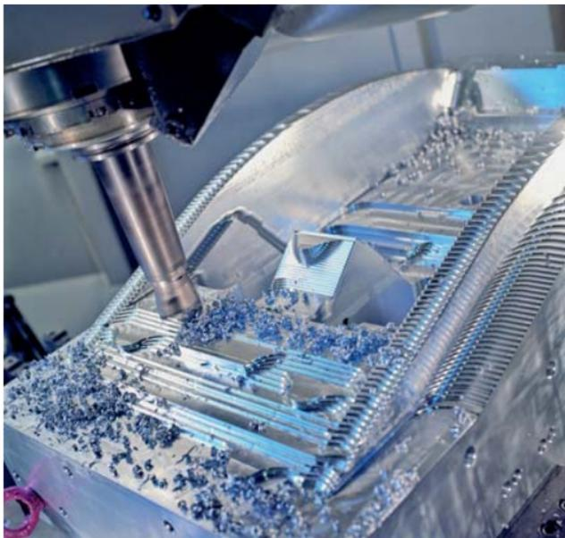
5 轴加工包选项功能除了可以实现刀具定向的 5 轴转换，还包括多轴插补 (M15) 选项功能。
