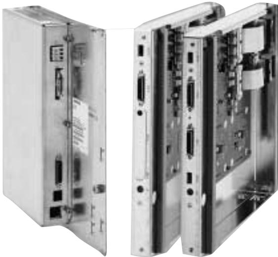
用于分布式安装的视频连接组件可以实现 SINUMERIK 操作面板和 SINUMERIKPCU 的分布式连接，且可将多达三个同样的操作面板连接到一个 PCU 上。
