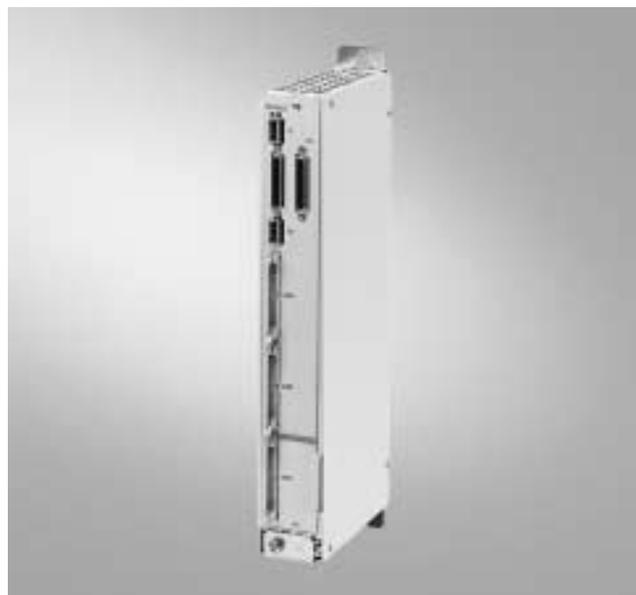
单一 I/O 模板 (EFP) 有 64 点输入和 32 点防短路输出。输出电流总和为 12A，也就是说：当同时使用系数为 0.75 时，32 点输出中每点输出电流为 0.5A。
